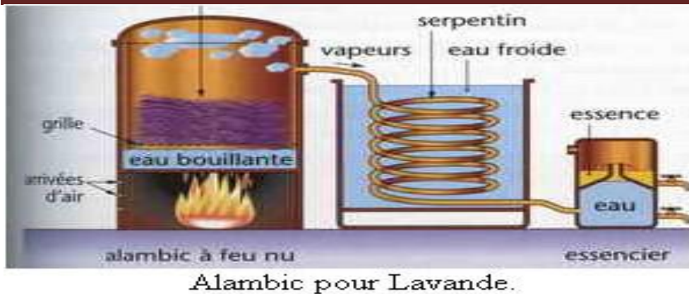
Figure 7 : Schéma du principe de la technique de l'entraînement à vapeur [67].
