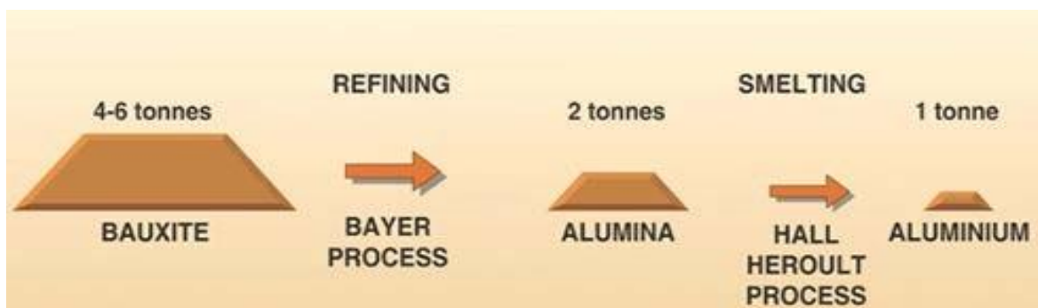
Figure 16: Schéma de processus global de raffinage et de fusion de bauxite [14]
