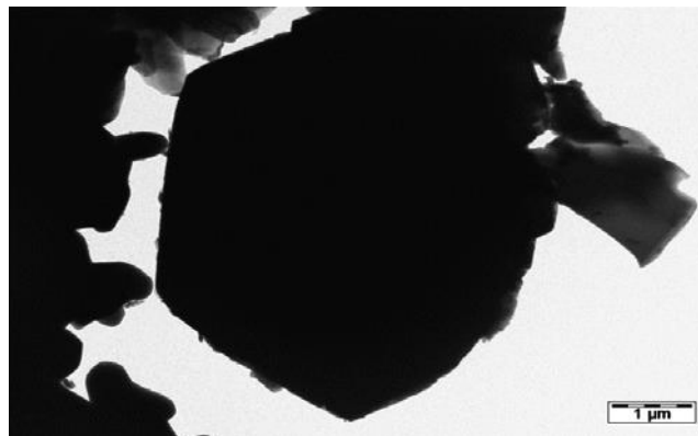
Figure 39: Image MET (A) de la gibbsite brute à 1 µm
