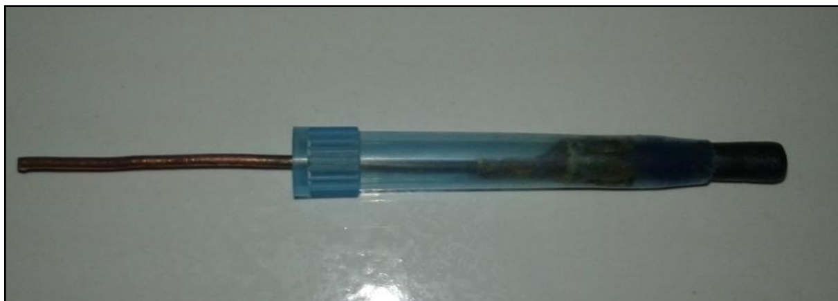
Figure 3.2. L'électrode de graphite.
