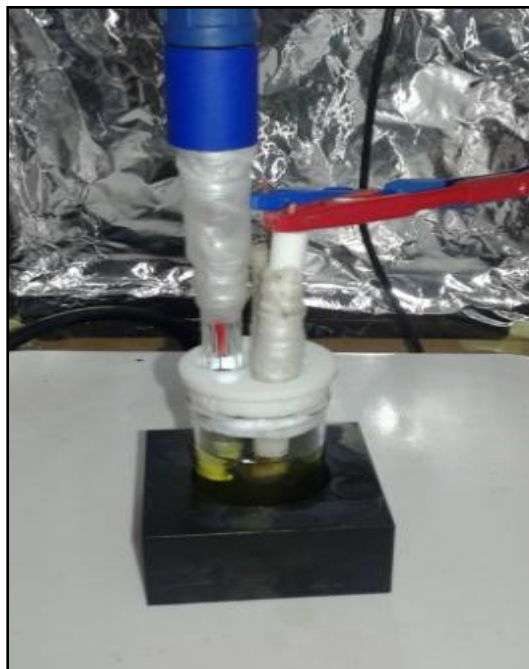
Figure 3.1. Cellule de mesure électrochimique.
