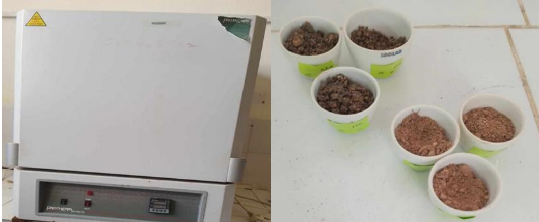
Figure N° 09 : Détermination de la Matière organique
