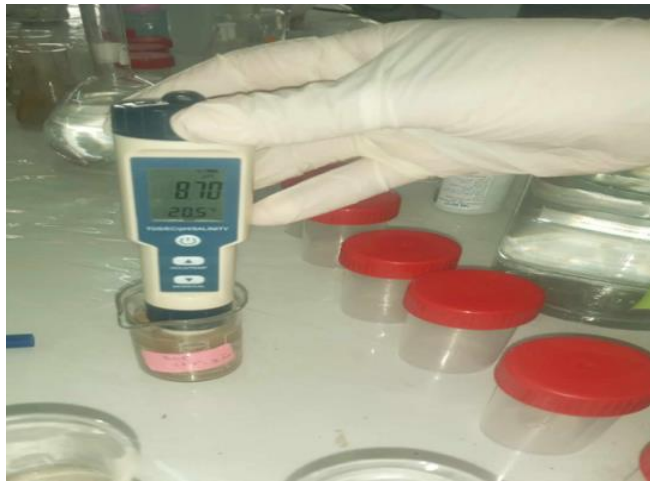
Figure N°08 : Mesure du pH de sol
