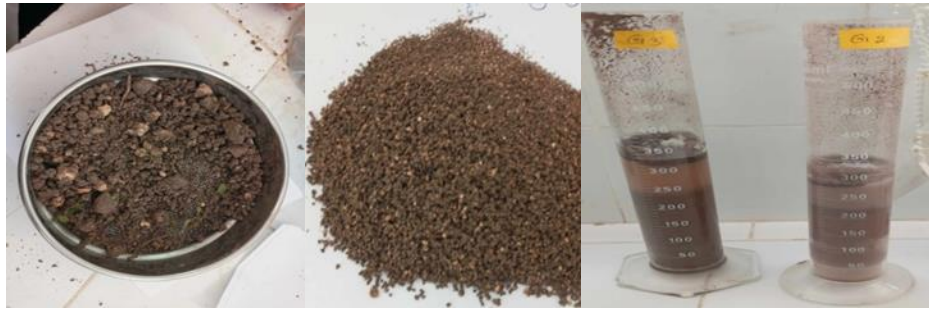
Figure N° 04 : La granulométrie (Tamisage et sedimentométrie)
