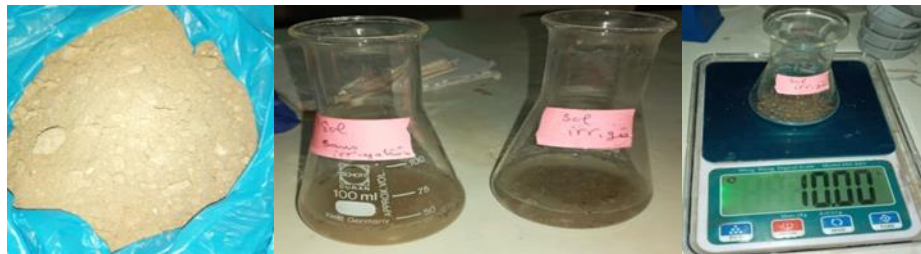
Figure N° 06 : Mesure de la Conductivité du sol
