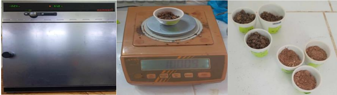
Figure N°05 : Mesure de l'humidité du sol
