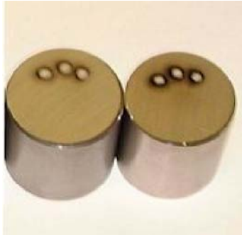
FIG.2 :Echantillons analysés par le spectrolab
