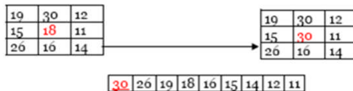
Figure 12 : Principe du filtre maximum
