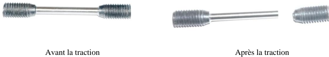
Figure III-24 : Les éprouvettes de l'acier XC10 cémenté pendant 2h avant et après traction.
