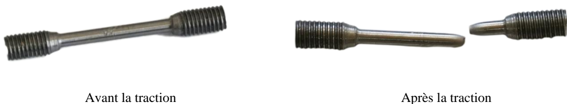
Figure III-23 : Les éprouvettes de l'acier XC10 brut avant et après traction.
