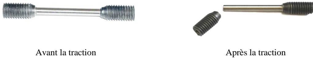
Figure III-25 : Les éprouvettes de l'acier XC10 cémenté pendant 4h avant et après traction.
