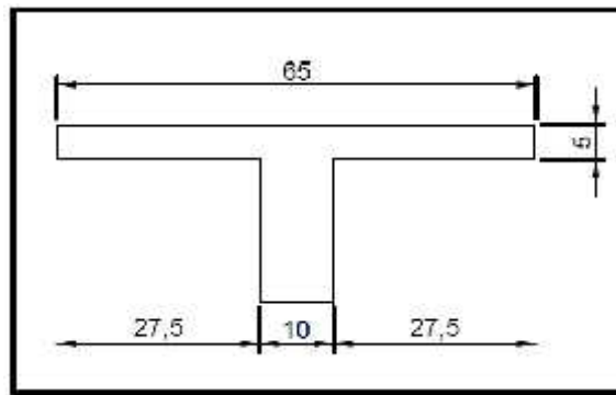
Figure II-10 : Dimensions adoptées des poutrelles.
