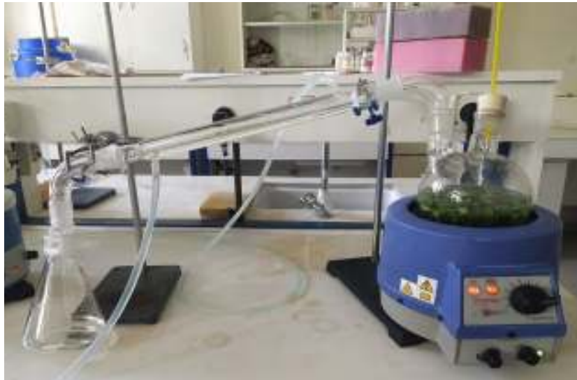
Figure26. Le montage de la technique d'hydrodistillation
