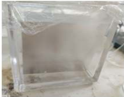
5- Nous avons mis la plaque dans la cuve fermer et laisser l'éluant diffuser.
