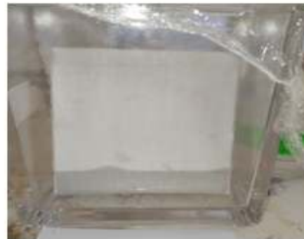
6- On arrête la CCM lorsque le front d'éluant est arrivé à 1 cm du haut de la plaque
