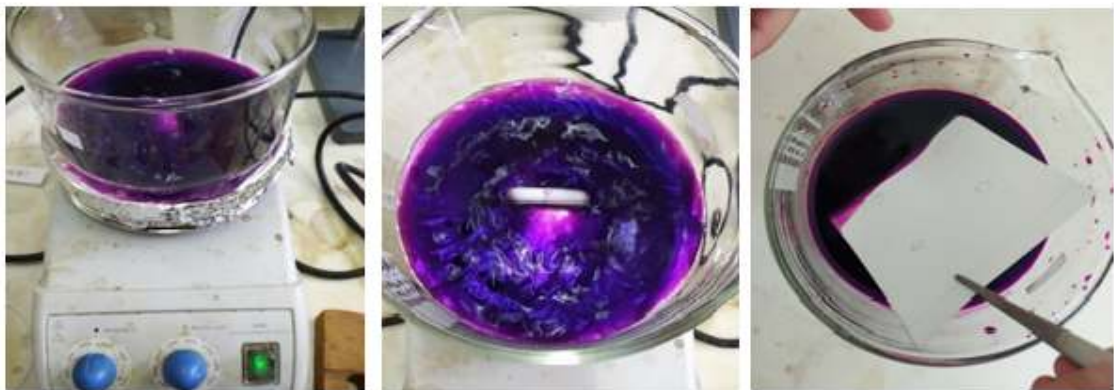
3- Nous trempions la plaque à chromatographie dans la solution de permanganate
