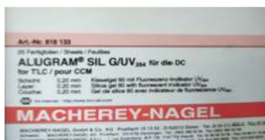
Figure32. Description de la plaque CCM en gel de silice
