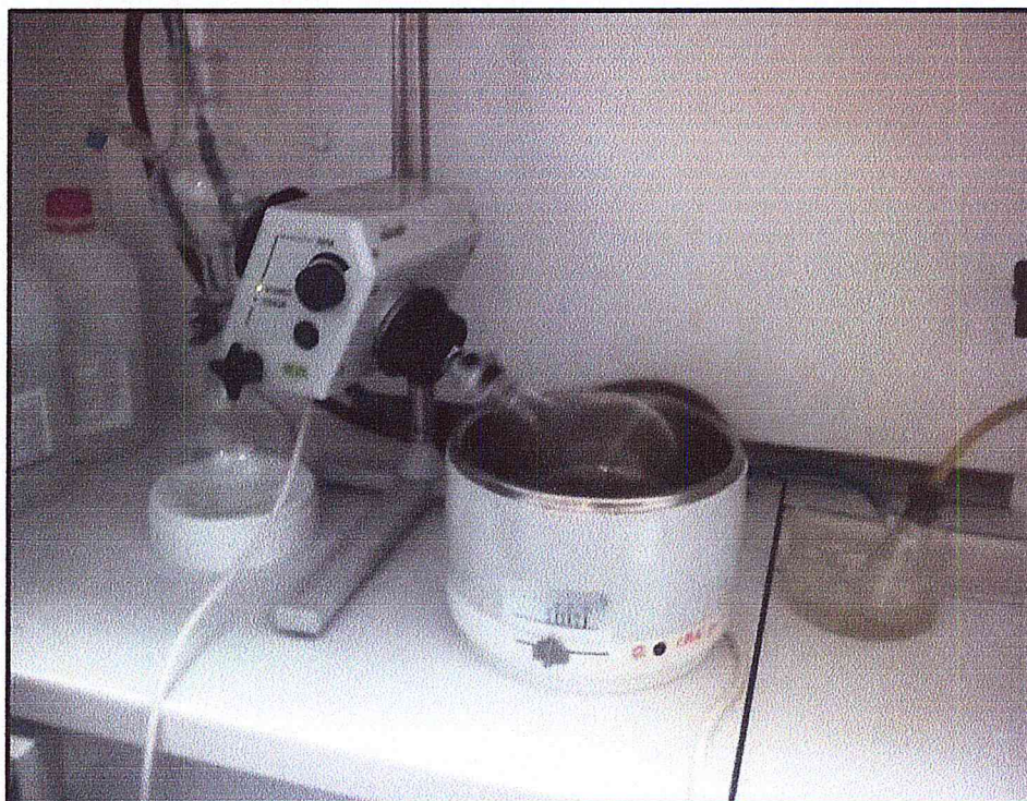
Figure 19. Photographie du Rotavapeur (Laboratoire SNV Universit  Khenchela)
