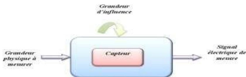
Figure I.6. Principe d'un capteur. [35]
