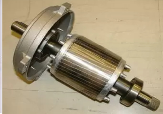
Figure 4: Vue d'un rotor cage d'écureuil
