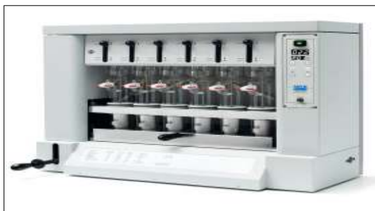
Figure I. 4 : Appareil d'extraction par solvants (Site web 5).
