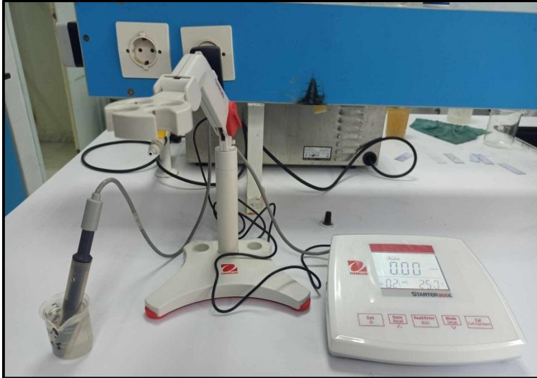
Photographie 5. Mesure de la conductivité électrique.
