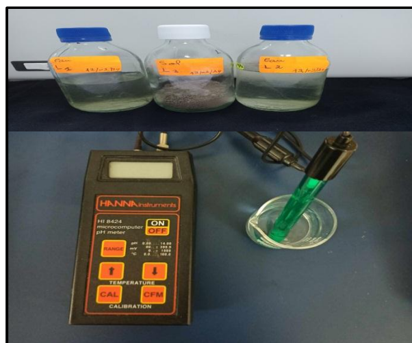
Photographie 4. Mesure de pH des trois échantillons.
