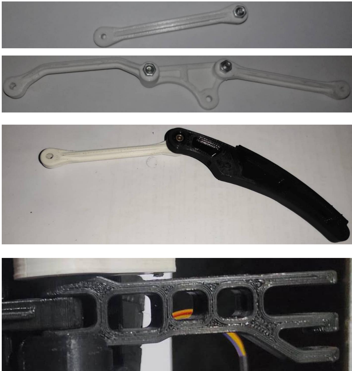
Fig.III.36. Les différents parties de ceps du bras
