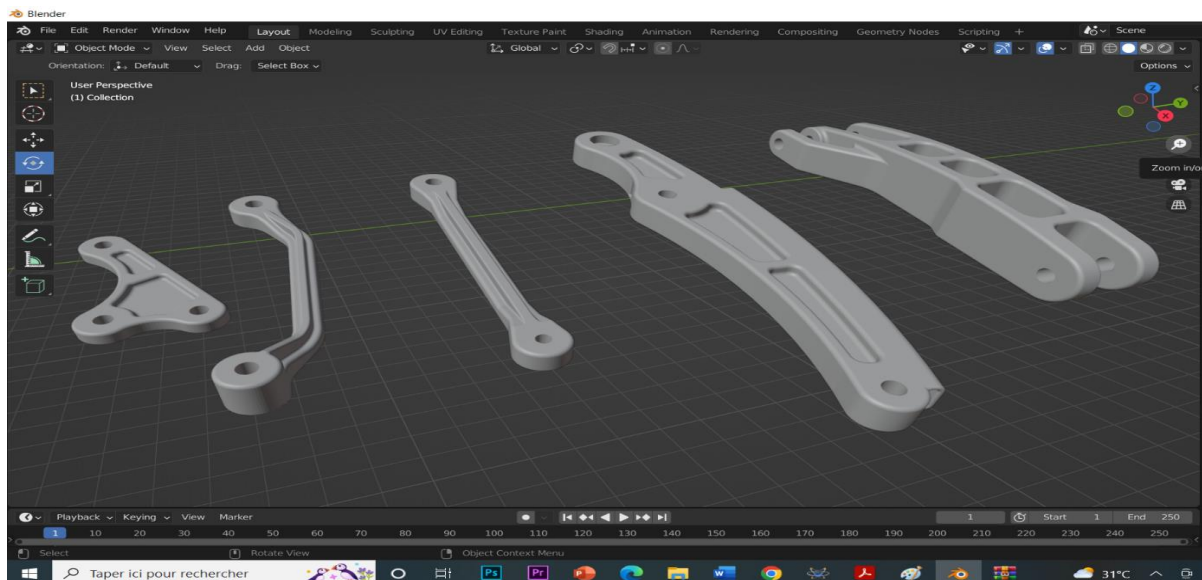
FigIII.30 Les différentes articulations de bras manipulateur :
