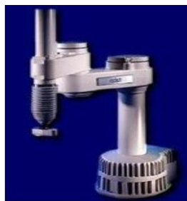
Fig.I.22. Structure d'un robot SCARA. [24]
