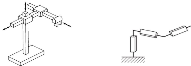
Fig. I.18. Structure d'un Robot cartésien. [9]
