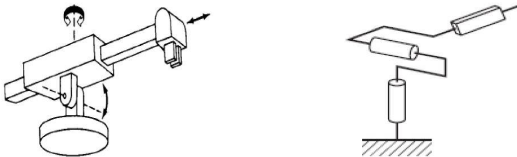
Fig.I.20. Structure d'un robot sphérique. [9]
