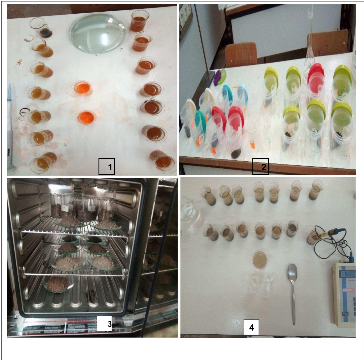
Figure 17. Quelques étapes des analyses physicochimique et biologiques réalisées au niveau du laboratoire. 1. MO, 2. Respirométrie, 3. Teneur en eau, 4. pH
