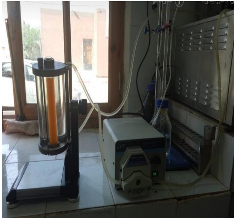
Photo 14 : Détermination de la viscosité d'huile des noyaux de dattes
