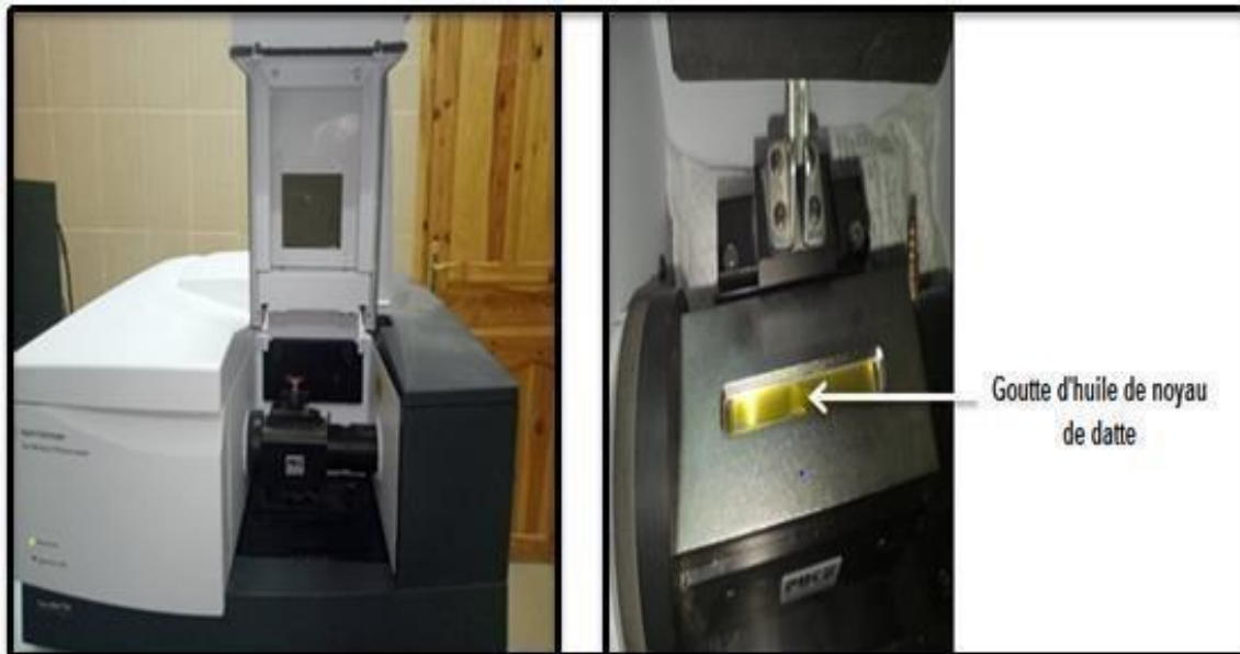
Figure 3-3 : Analyse spectroscopique IR d'huile des noyaux de dattes. (Réalisé au laboratoire de contrôle de qualité de monsieur bakha route ain beida - khenchela-)
