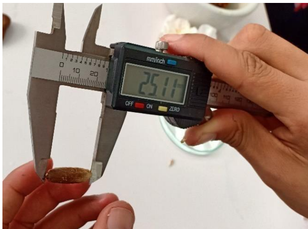
Photo 01 : détermination des mesures des noyaux à l'aide d'un pied de coulisse.
