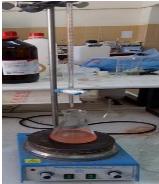
Photo15 : Le processus de titrage pour l'identification de l'indiced'acide
