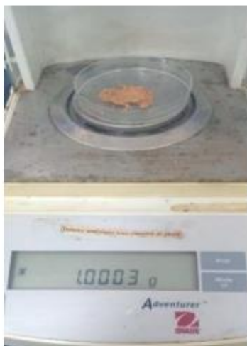
Photo 9 : pesage de noyaux de datte dans des capsules et dessiccation d'échantillons par dessiccateur et Balance analytique.
