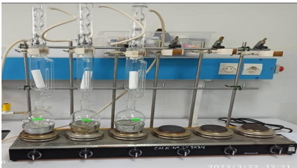
Photo 7 : l'appareil d'extraction par méthode de soxhlet.
