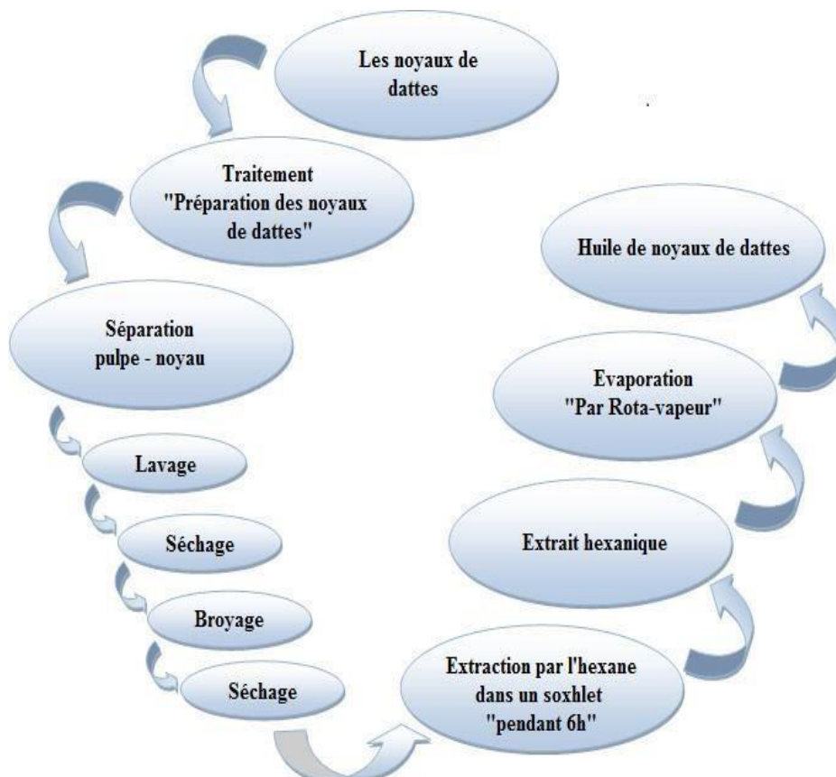
Figure 3-2 : Schéma d'extraction d'huile des noyaux de dattes
