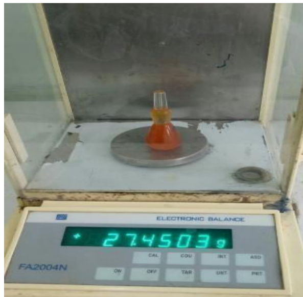
Photo 13 : La mesure de densité par un pycnomètre.
