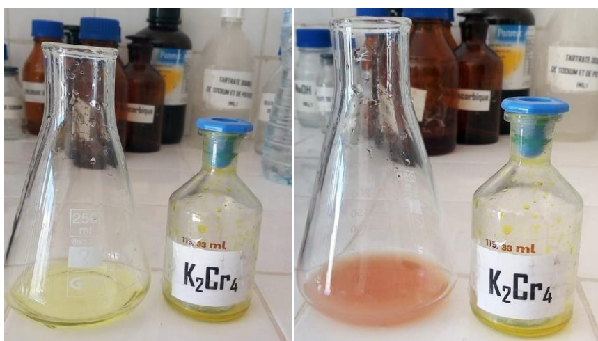
Figure 47: Dosage de chlorure
