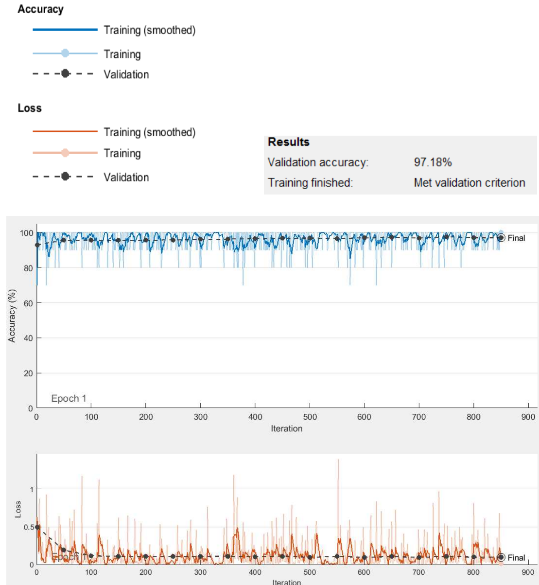
Figure IV. 17. Évolution des critères Accuracy et Loss en fonction du nombre d’itérations sur la base de données GNSS durant la phase d’apprentissage avec une entrée de dimension 64 \times 64 .
