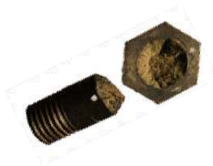
Fig .I.21 Aspect de corrosion sous contraintes d'un boulon.
