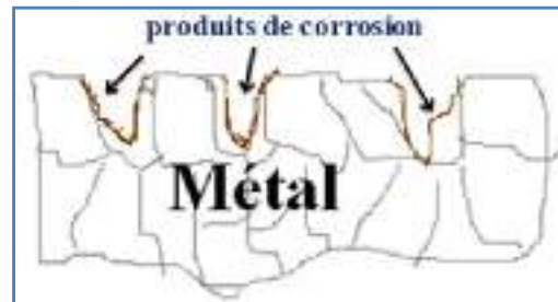
Fig .I.13 Corrosion caverneuse (par crevasses).
