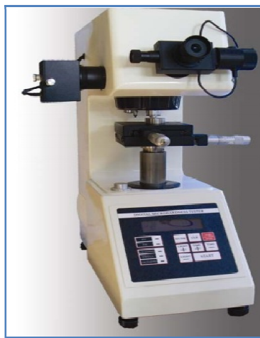
Fig.III.6. Microduromètre de type AFFRI 1-21056 INDULODONA.
