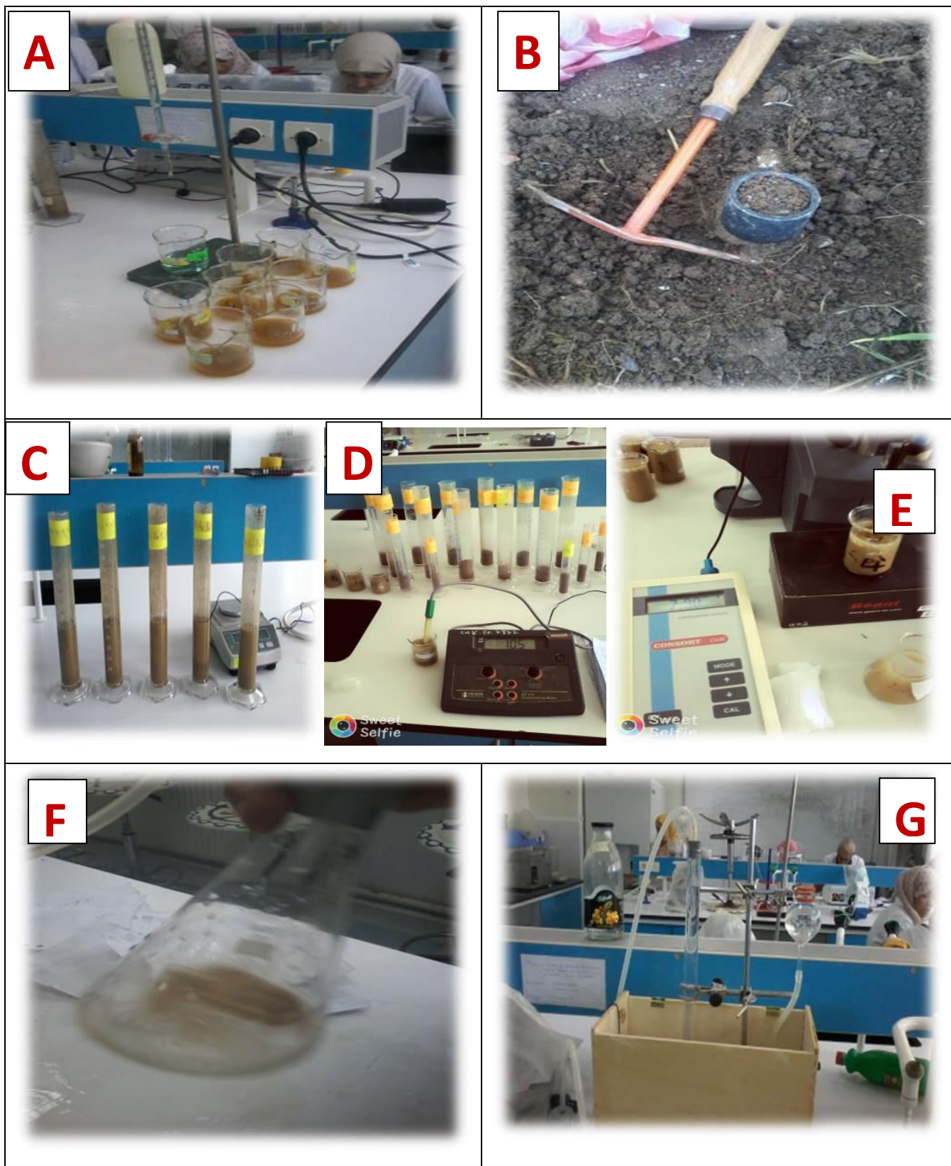
Figure 7. Quelques étapes des analyses physicochimiques de sol réalisés A) Dosage de MO. B) Cylindre pour la mesure de la Da. C) Mesure de la granulométrie. D) Mesure là CE. E) Mesure du pH. F et G) Mesure du calcaire totale su sol
