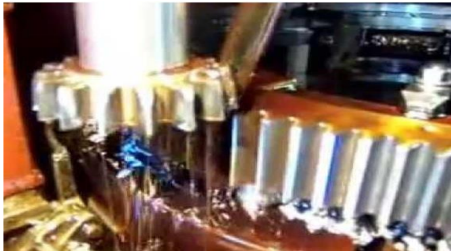
Fig.19. Exemple de taille avec outil pignon, source [4]
