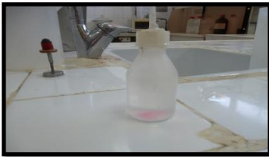
Figure 03 : Mesure de l'acidité par test de Phénol phtaléine
