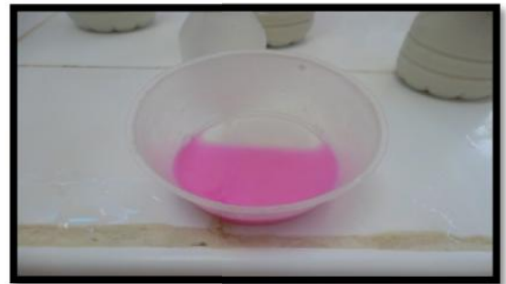
Figure 03 : Mesure de l'acidité par test de Phénol phtaléine
