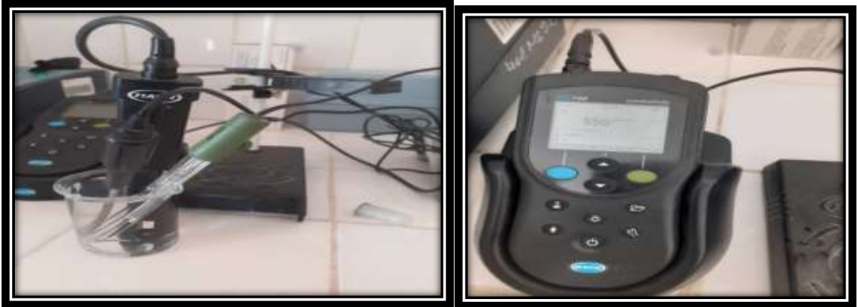
Photographie3. Multi paramètre qui mesure la conductivité électrique du l'eau
