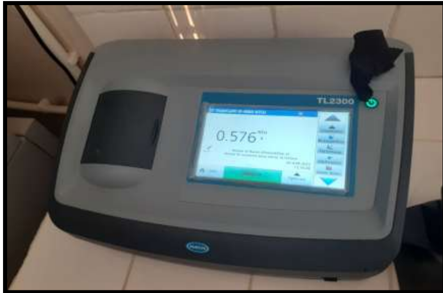
Potographie4. Turbidimètre qui mesure la turbidité
