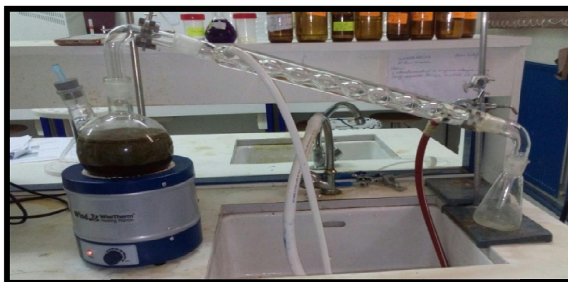
Figure 12: l'appareil d'hydro distillation (Originale 2019).
