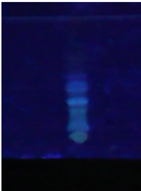
Figure 12: Photo de chromatogramme résultant de l'analyse d'extrait méthanolique par chromatographie sur gel de silice par le système solvant : Chloroforme : acétate d'éthyle : acide formique (50 : 40 :10) (Révélation à l'UV), \lambda=365 nm
