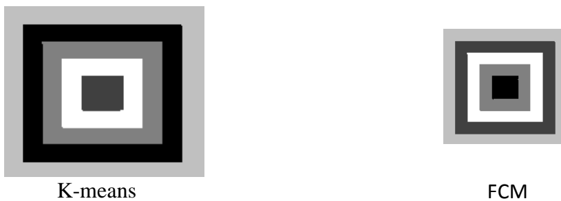
Figure II.5 : Résultats de la segmentation de l'image synthétique 1 par les deux méthodes
