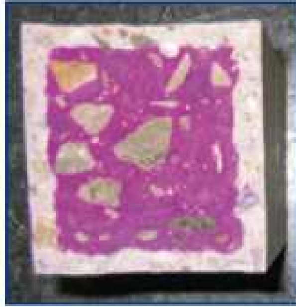
Figure II -30: Section d'éprouvette partiellement carbonatée, avec mise en évidence de la zone carbonatée (incolore) par la phénolphthaléine. [11]
