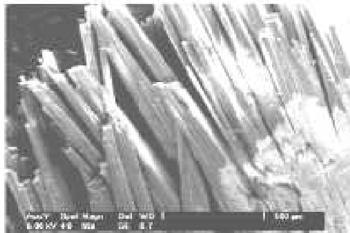
Figure II -5 : La formation de l'ettringite secondaire.
