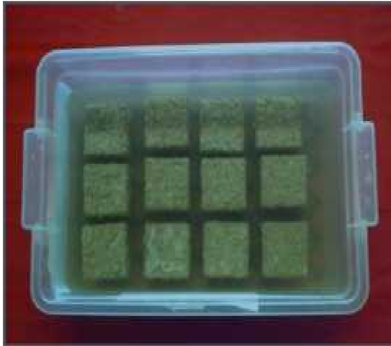
Figure II -12 : Eprouvettes cubiques 50x50x50mm immergées dans la solution acide.
