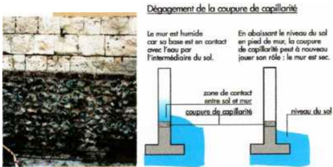
Figure II -39 : Dégagement de la coupure de capillarité. [12]
