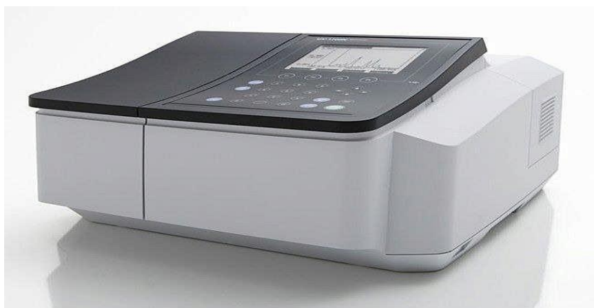
Figure II.10. Dispositif expérimental de la spectroscopie UV-visible.
