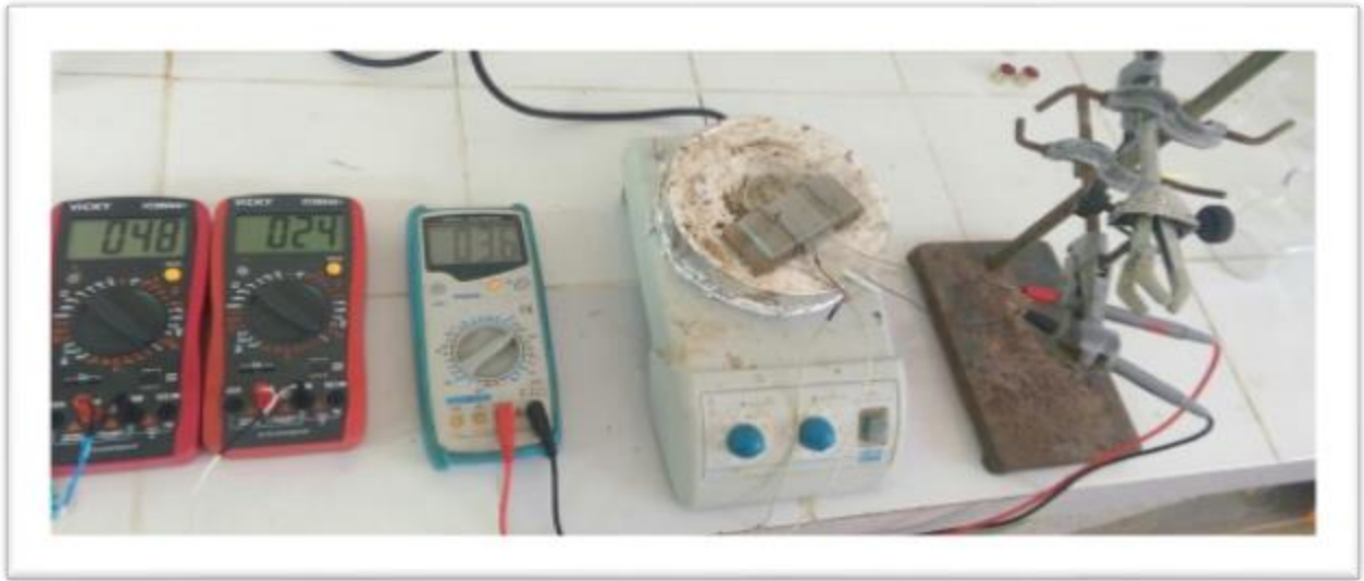
Figure II.8. Dispositif expérimental de mesure du coefficient Seebeck pour les couches minces de ZnO:Sn
