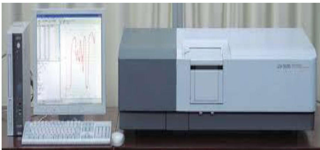
Figure. II.13: (a) Spectres de transmittance d'un échantillon ITO ; (b) dispositif expérimental UV-3100 PC utilisé pour les mesures UV-Visible.
