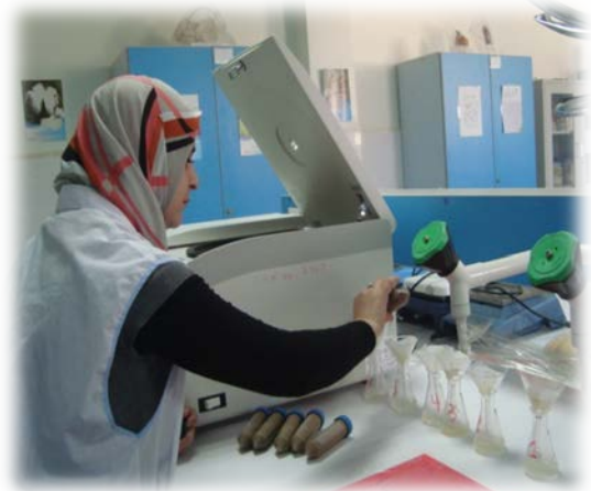
Photos n°12: La filtration de l'extrait de la pâte saturée
