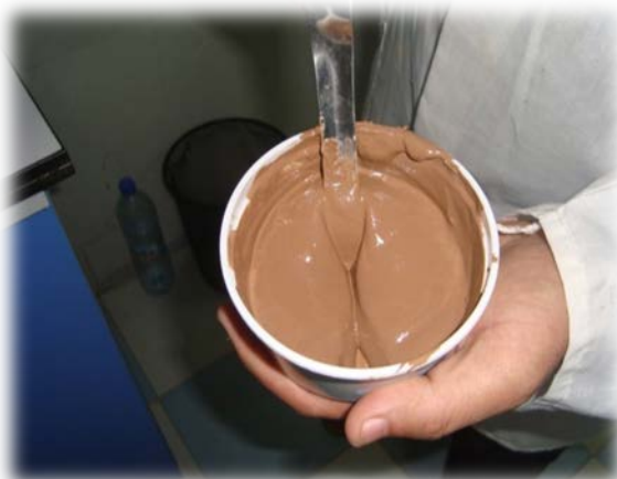
Photos n°7 : La fente de la pâte saturée.
