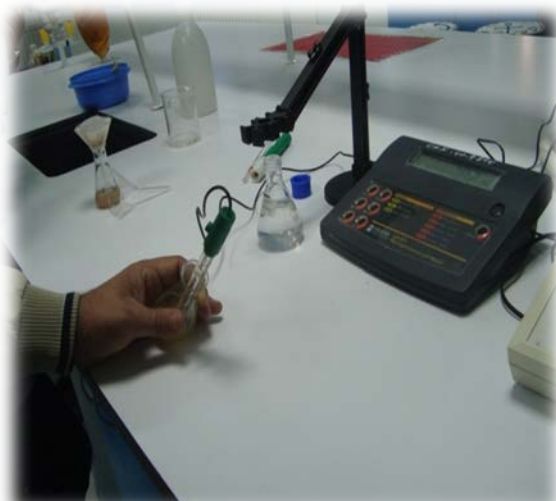
Photos n°16: Mesure de CE, TDS, PH.
