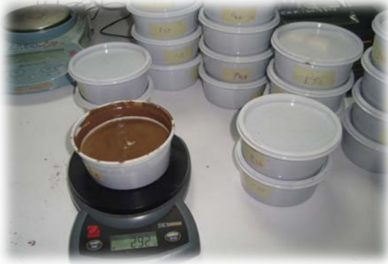
Photos n°9 : Mesure la pâte saturée après 24h
