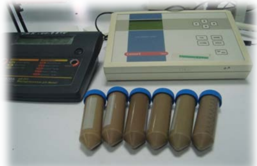
Photos n°10: la pâte saturée dans le tube de centrifuges
