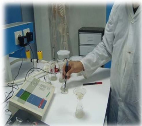
Photos n°14: Mesure de la (CE, TDS).
