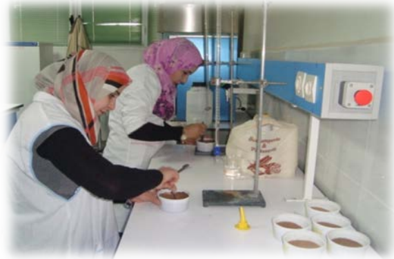
Photos n°6 : l'ajout progressif de l'eau distillée
