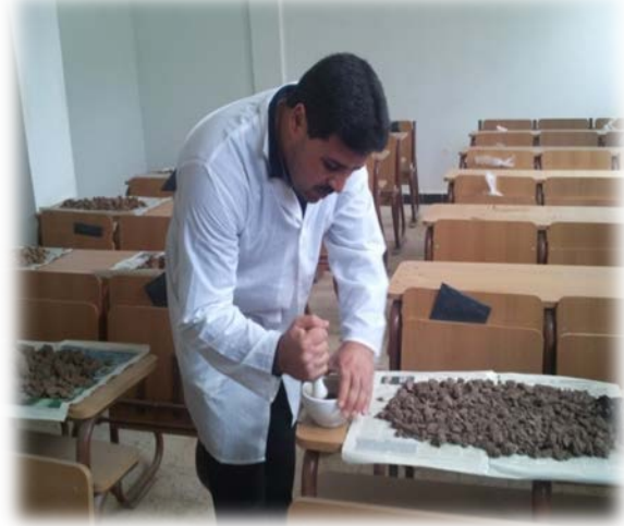
Photos n°4: Broyage d'échantillons du sol
