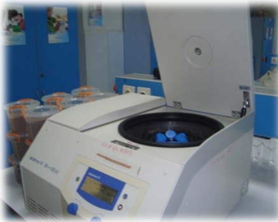
Photos n°11 : Passage de la pâte saturée au centrifuges
