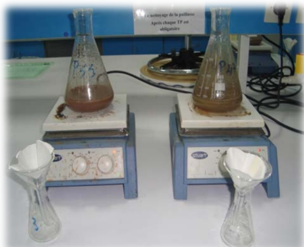
Photos n°15 : L'agitation de solution (2h).
