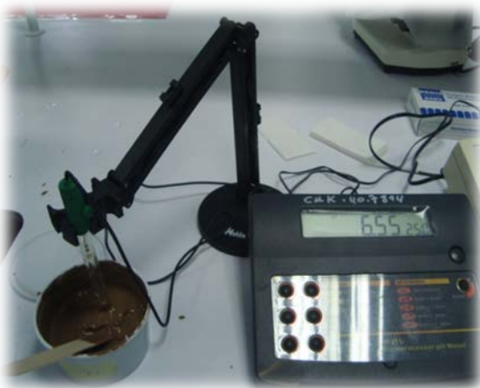
Photos n°13: le pH mètre mesure (ph)
