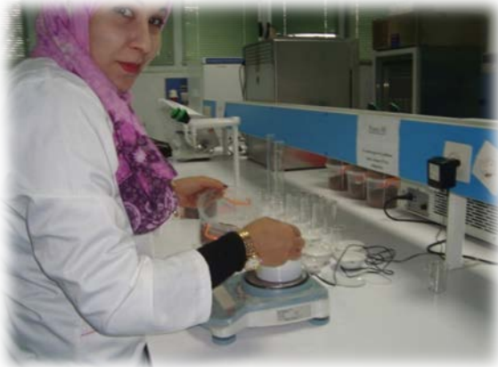
Photos n°5 : Pesons l'échantillons du sol
