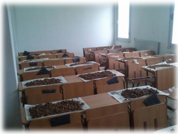
Photos n° 3: Préparation et séchage d'échantillons du sol
