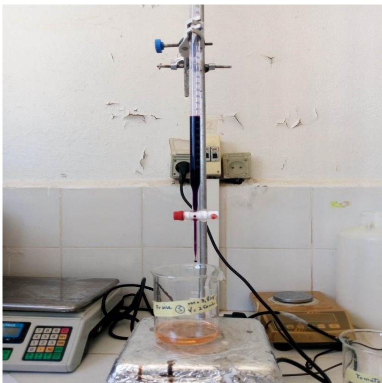
Figure 8 : Equipment du titrage (Photo personnelle).
