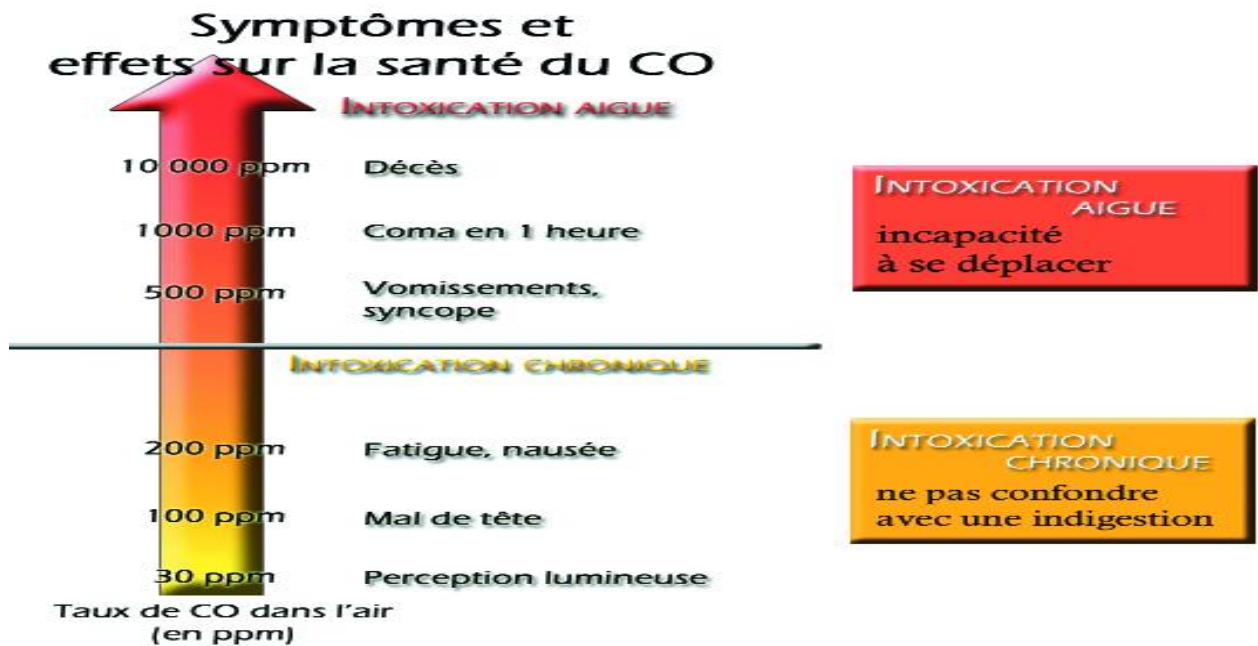
Figure 14: Symptômes et effets sur la santé du CO : intoxications aiguë et chronique (Geronimi , 2000 ; Viala , 1998).
