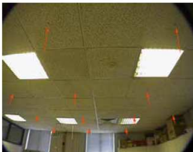
Figure I. 5. Système Active BAT: Les récepteurs ultrasons.
