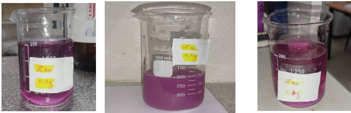
Figure 18 : Solution préparée de différentes masses (0.2g, 0.5g, 0.8g et 1g) de catalyseur (TiO 2 et ZnO).
