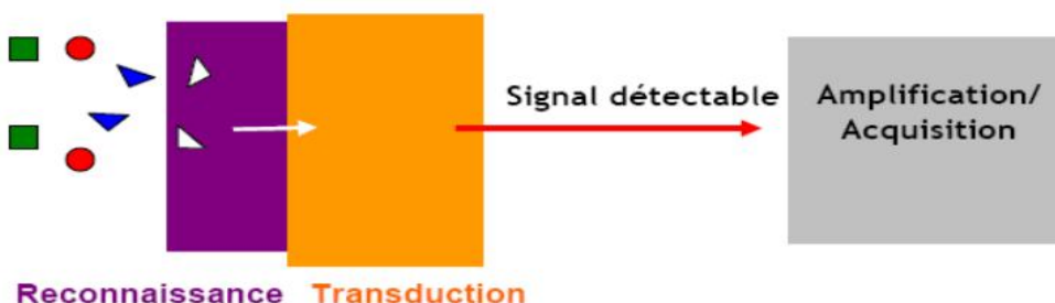
Figure 0.9 . Schéma de principe d'un capteur chimique
