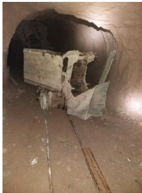
Figure II-7: Pelle sur rail de chargement, filon n°4.
