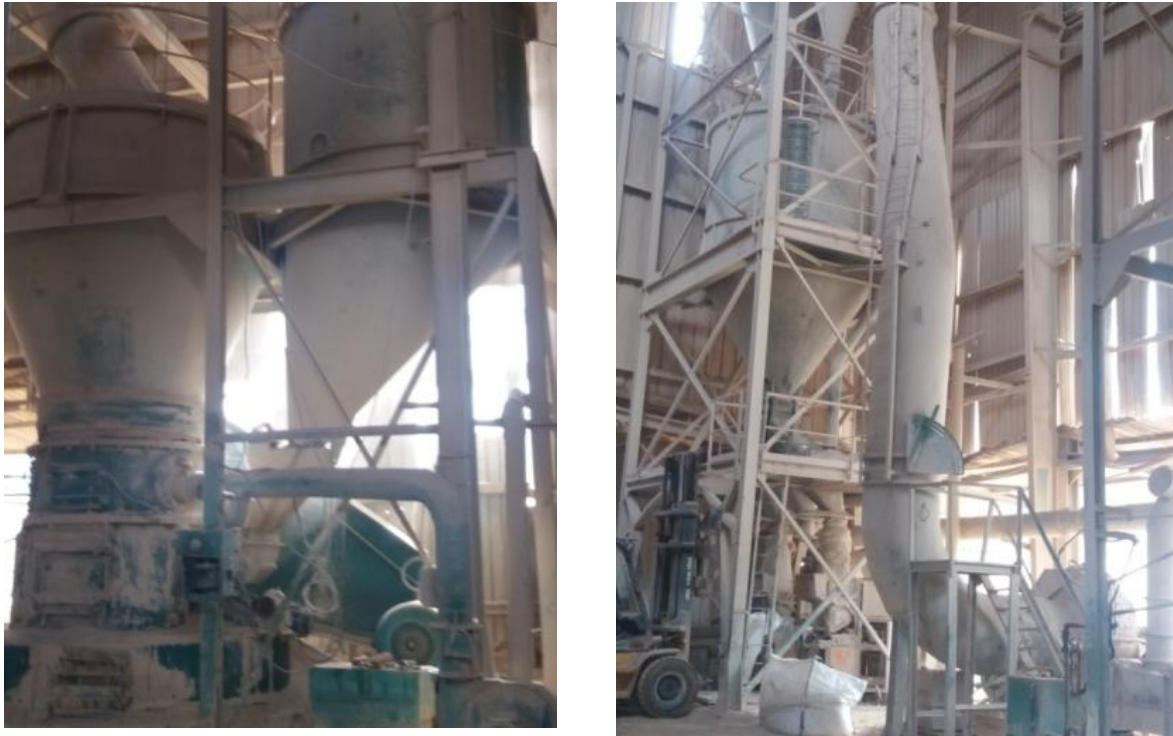
Figure II-17: Le broyage du produit semi-fini jusqu'à 70 \mu\text{m}
