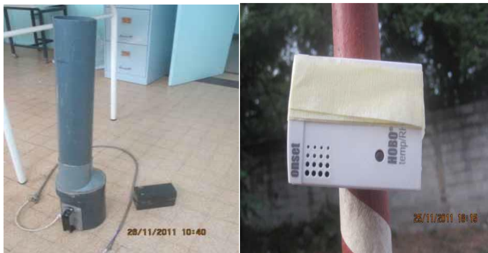
Figure 23 : Aspirateur avec batterie de 12volts à gauche et un enregistreur de température et D'humidité relative de type HOBO à droite (Dusom M 1987).
