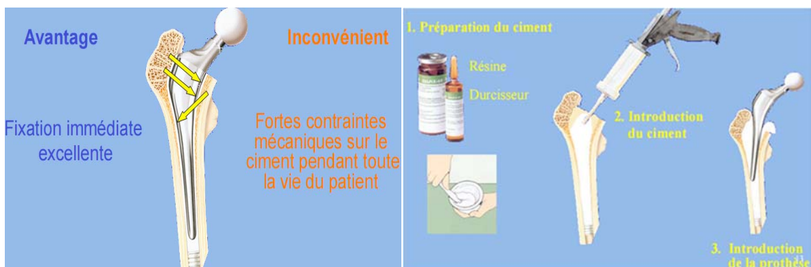
Figure II-3 : Fixation par ciment : a- Préparation du ciment, b- Exemple de fixation cimentée [7].
