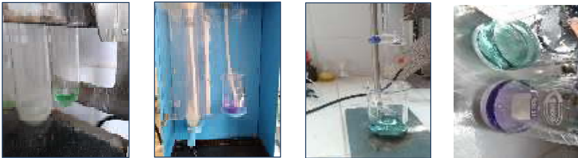
Photographie 04 : Etapes de la méthode de Kjeldahl pour dosage d'azote
