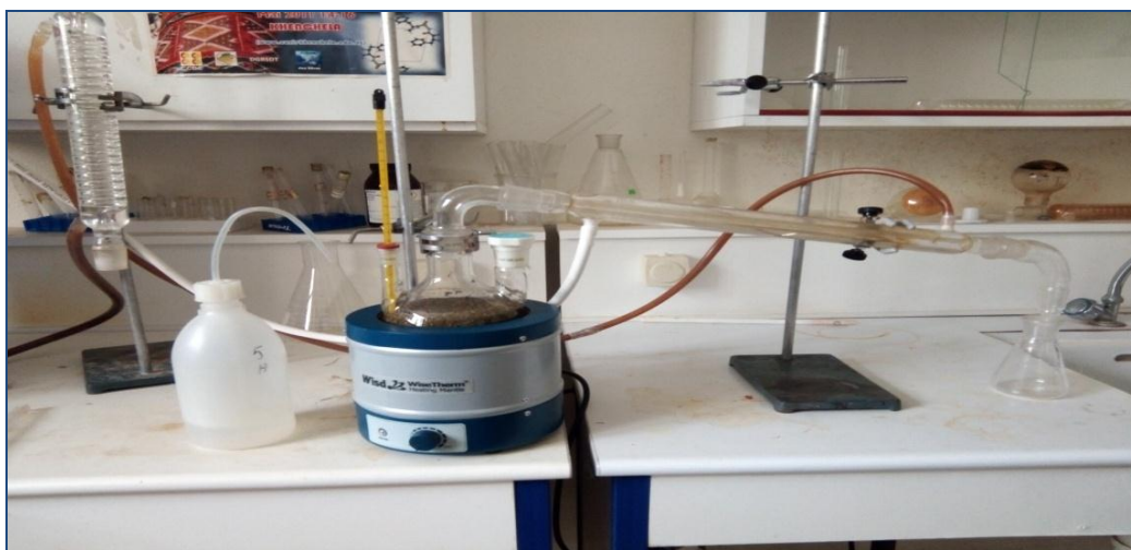
Figure III.17: Montage d'hydrodistillation utilisé pour détecter les huiles essentielles dans la plante étudiée.
