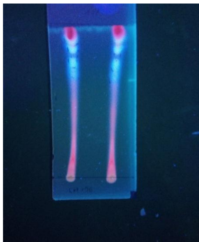
Figure IV.1: photo de chromatographie résultant de l'analyse de l'extrait MeOH avec révélation à l'UV.
