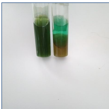
Figure III.16: Test d'identification des sucres réducteurs.
