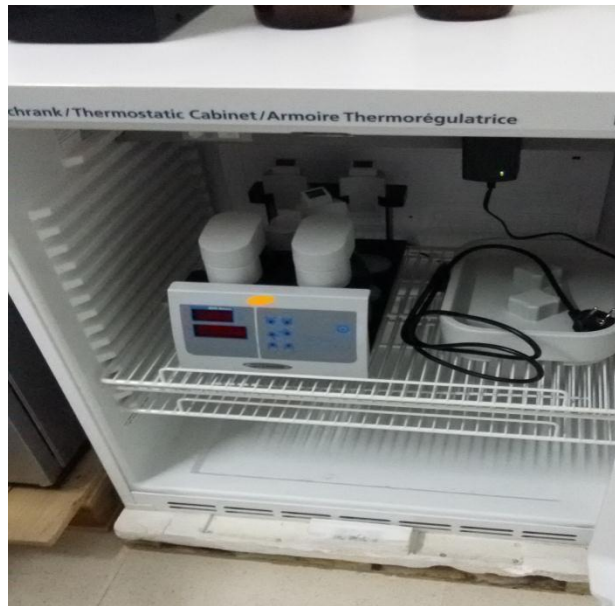
Figure 19: La mesure de DBO5 dans 5 jours dans une armoire thermorégulatrice.
