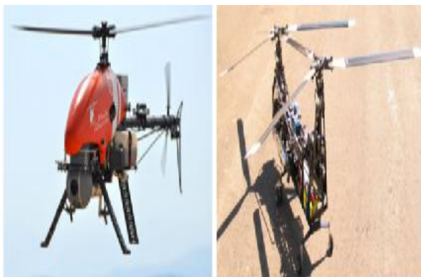
Figure I.10. Hélicoptère classique (à gauche) Hélicoptère en tandem (à droite).
