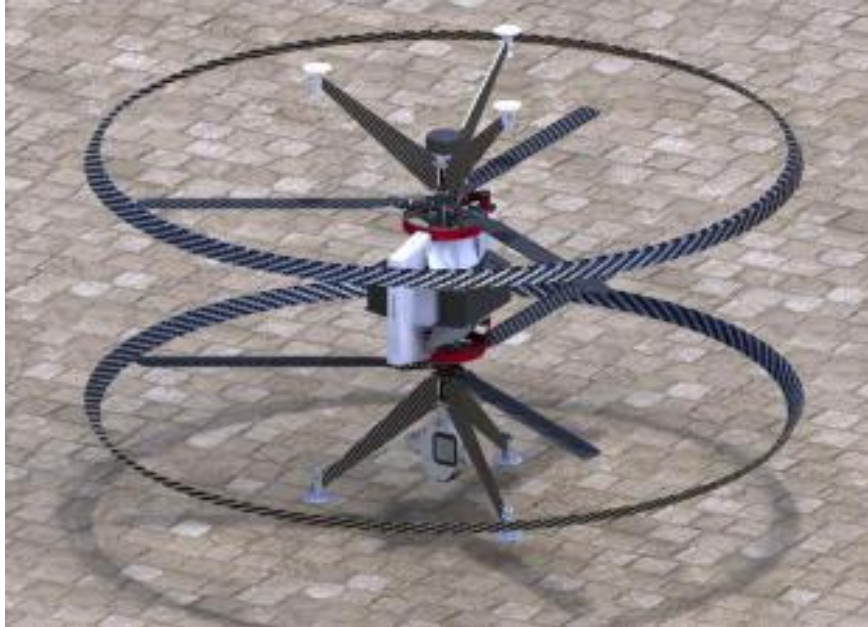
Figure I.11. Drone à deux hélices co-axiales.
