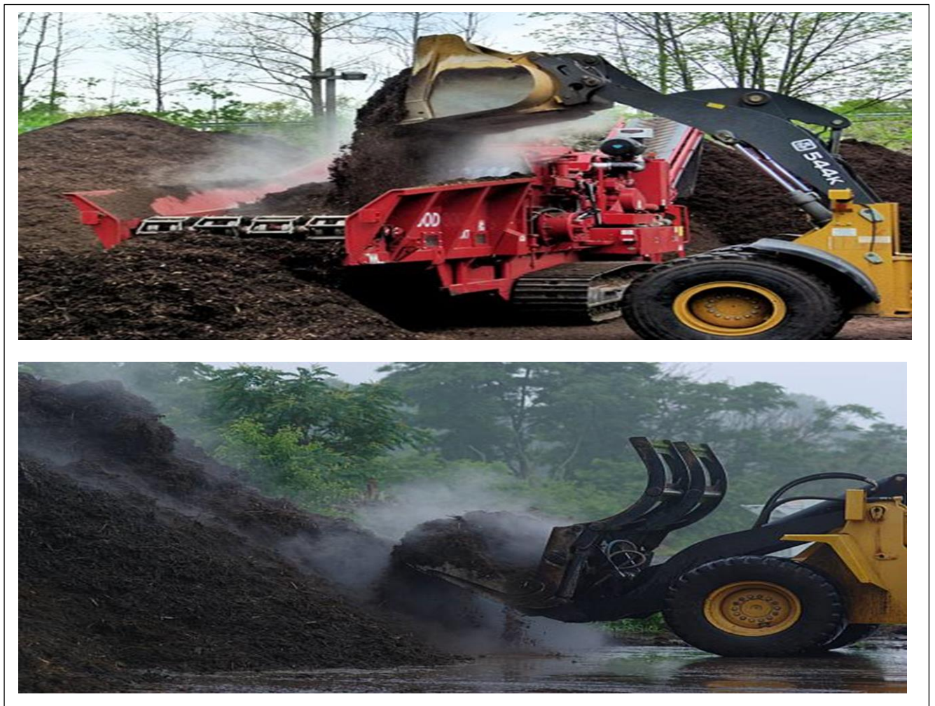
Figure 11. Aération mécanique au cours du processus du compostage
