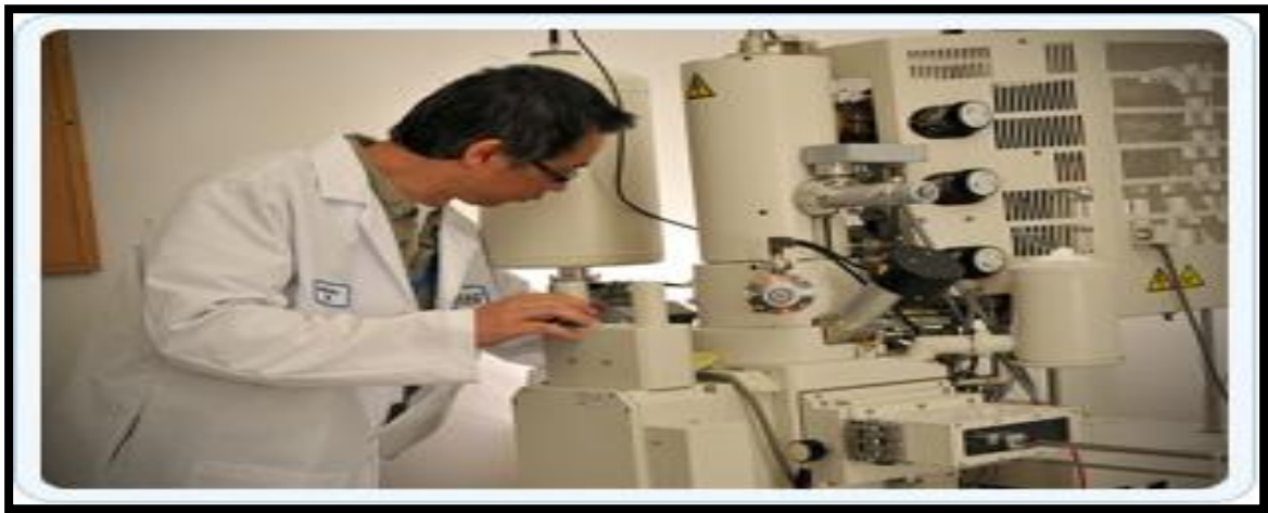
Figure. II. 15: Spectroscopie à rayons X à dispersion d'énergie, analyse EDS [27].
