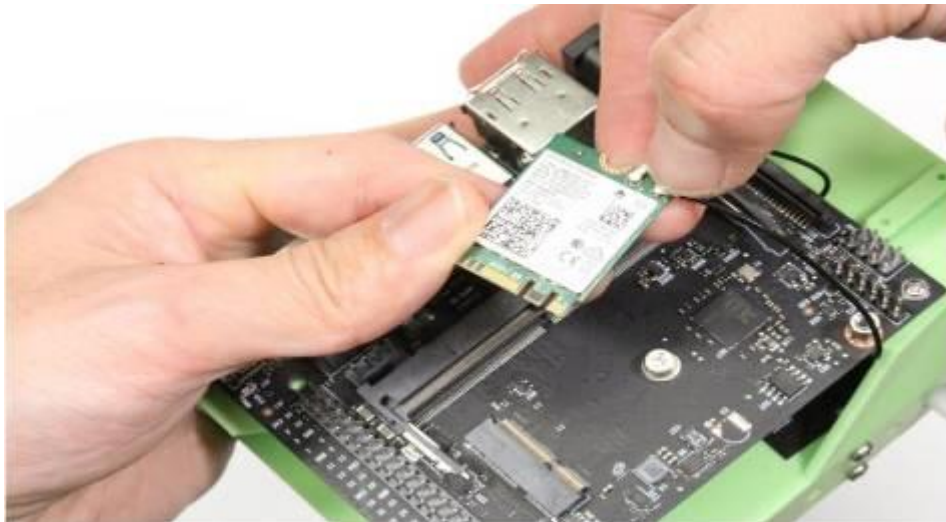
Figure II. 10. Fixation du module Wi-Fi dans le NVIDIA Jetson Nano.
