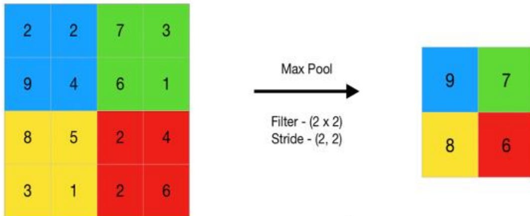
Figure I. 12. Max Pooling avec filtre 2 \times 2 et un pas 2.
