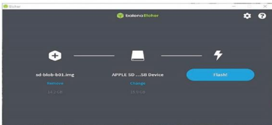
Figure II. 3. Flasher le fichier image NVIDIA sur la carte MicroSD avec Etcher.
