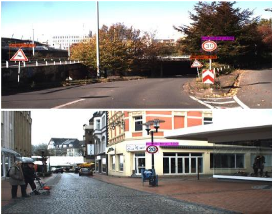
Figure III. 35. Les résultats des images testées par YOLOv3-tiny.
