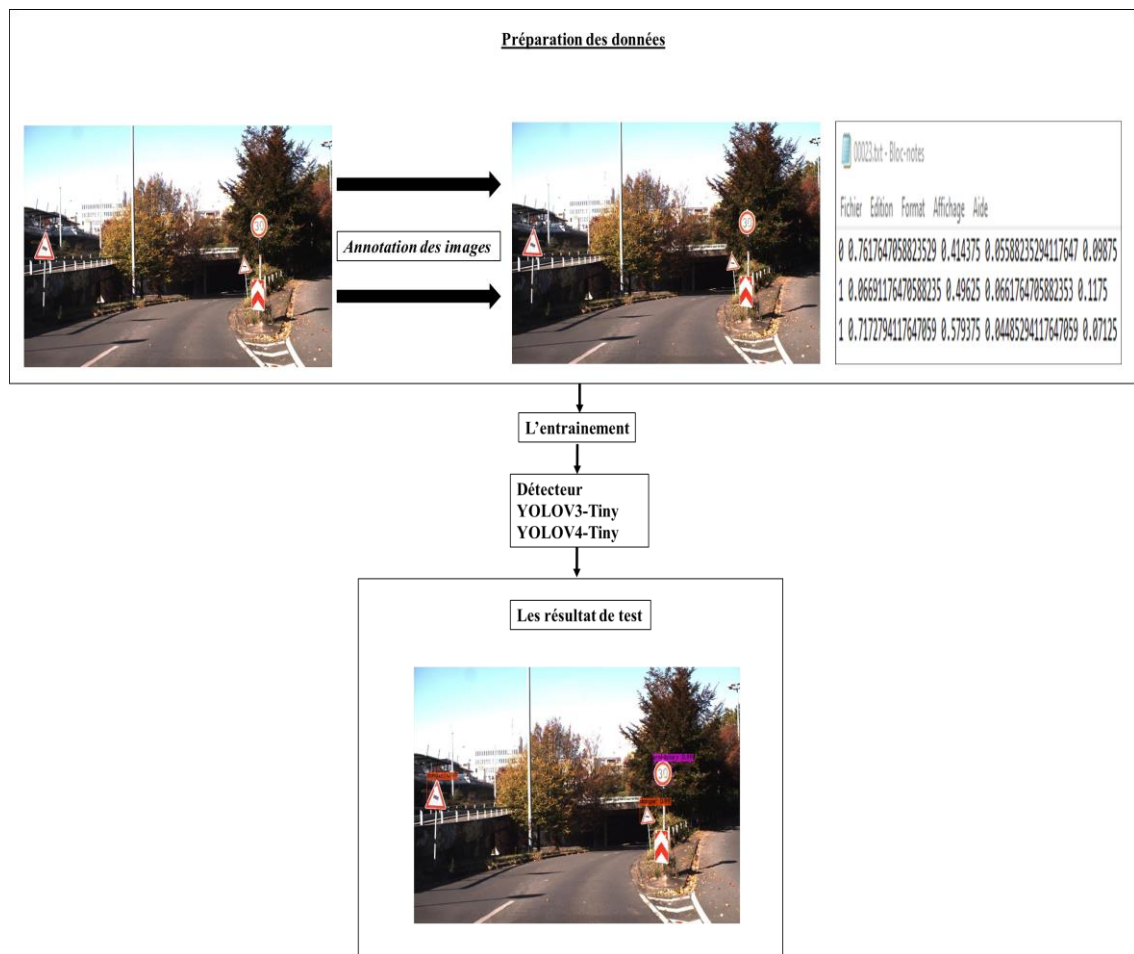
Figure III. 28. La procédure de développement de modèle de détection des panneaux routière.
