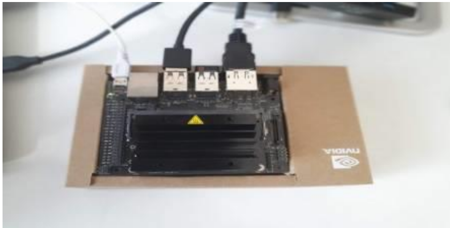
Figure II. 11. Branchement de l'USB WIFI au NVIDIA Jetson Nano.
