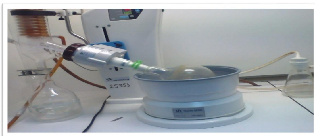
Figure 7 : Photo du Rotavapeur utilisé pour sécher nos extraits méthanoliques
