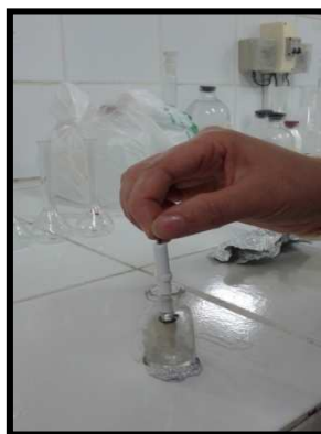
Figure 3-7 Dépôt de la membrane sur la surface de l'électrode d'or.
