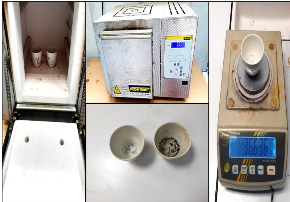
Figure 15: Processus de détermination des cendres de vinaigre de pomme
