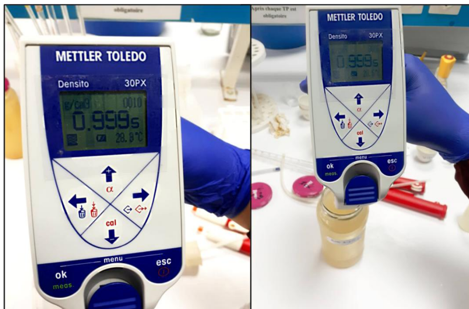
Figure 12: Mesure de la densité de vinaigre de pomme
