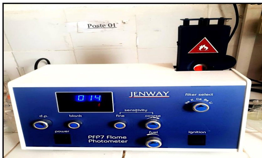
Figure 20: Dosage des cations \text{Na}^+ , \text{K}^+ et \text{Ca}^{2+} dans le vinaigre de pomme
