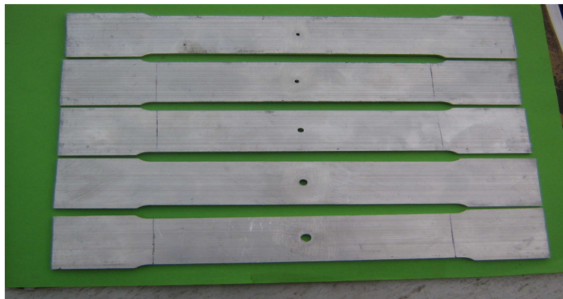
Fig.II.4. Éprouvettes percées de diamètres (1-2-3-4-5) mm
